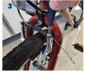
3. Loosen the cable pinch bolt.
